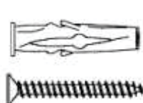
ANKERDÜBEL MIT NYLONFLÜGELN
